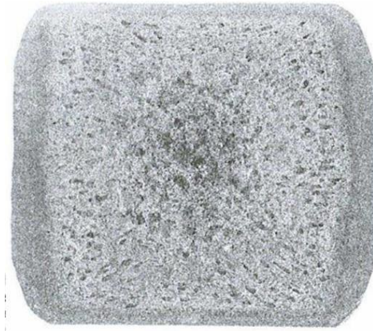
Şekil 4. Kükürdün malzeme içinde dağılımı.
