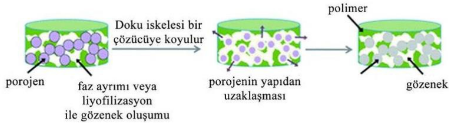
Şekil 3 Çözücü döküm/partikül uzaklaştırma yönteminin şematik gösterimi [6]
