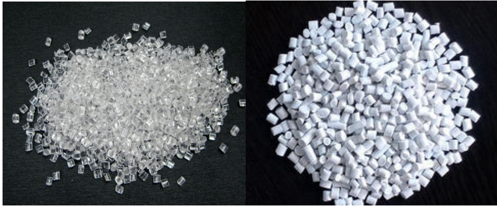
(a) Genel amaçlı kristal PS ve (b) Antişok PS granülleri.
